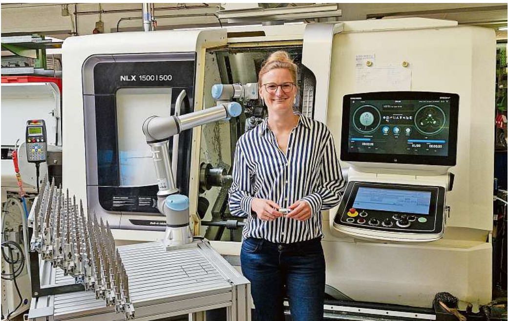
Theresa Usbeck-Pohlig führt das Radevormwalder Unternehmen Usbeck bereits in fünfter Generation. An der Drehmaschine im Hintergrund werden Sondermuffen gedreht. Ein Roboterarm übernimmt dabei einen Teil der Arbeit.
